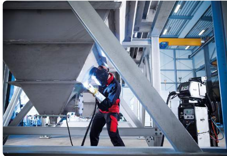
Neben dem Schweißverfahren MIG/MAG werden alle notwendigen Materialien, Hilfsstoffe sowie Einstellungen beschrieben. Dazu gibt es hilfreiche Grafiken und Tabellen. Neue Anwendungsbilder zeigen Beispiele aus der Praxis, wie hier das MAG-Schweißen eines Trichters aus CrNi-Stahl.
