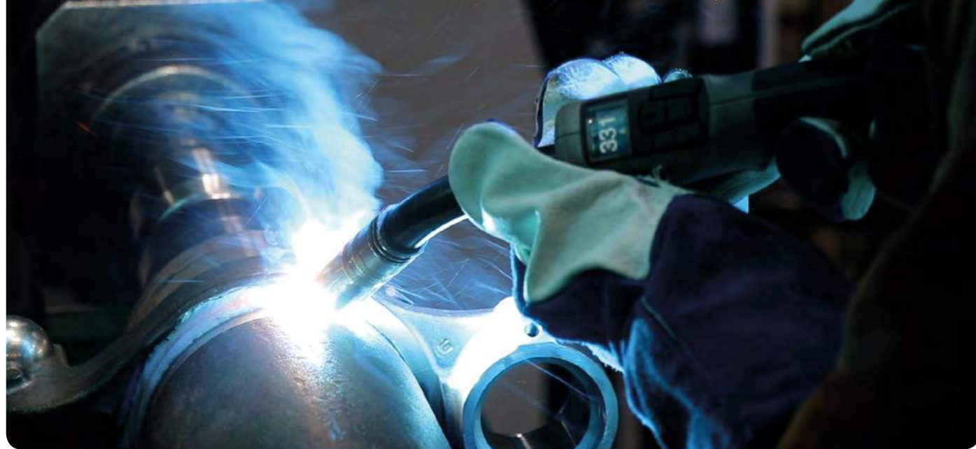
Die wärmeminimierten, richtungsstabilen und druckvollen Lichtbogen mit tiefem Einbrand im oberen Leistungsbereich ermöglichen eine Reduzierung von Schweißzusatzwerkstoffen. Aufgrund des geringen Spritzeraufkommens ist zudem weniger Nacharbeit erforderlich. Quelle: EWM
